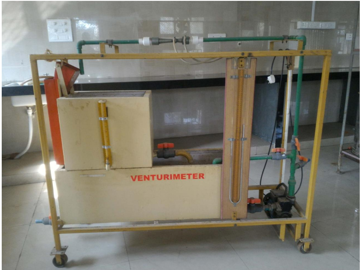
Set up2: Venturi meter
